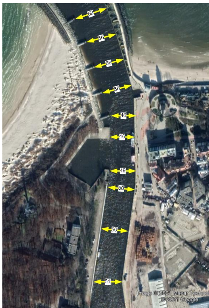
Rys 3.1 Dostępne szerokości maksymalne kanału portowego w Kołobrzegu
