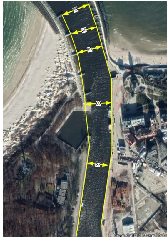
Rys. 1. Zakres projektowanej przebudowy drogi wodnej w Porcie Kołobrzeg wg wariantów A i B (linie żółte)
