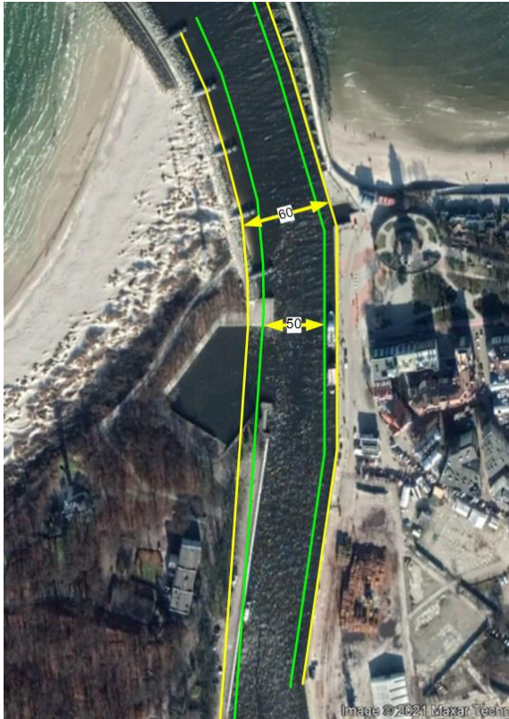
Rys. 1. Zakres projektowanej przebudowy drogi wodnej w Porcie Kołobrzeg wg wariantów A i B (linie żółte)
