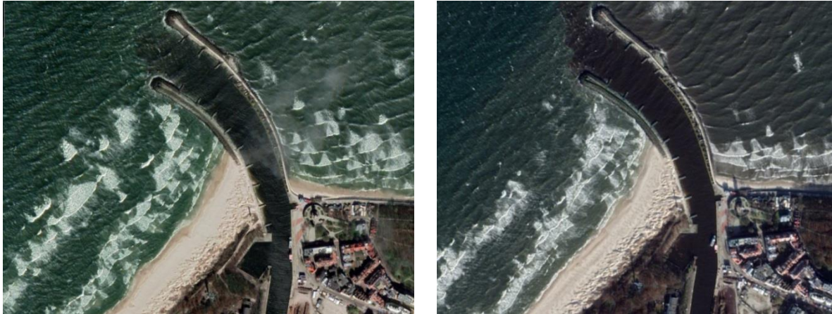
Rys. 14. Przenikanie umiarkowanego falowania z sektora W-N do Portu Kołobrzeg (fot. Google Earth)
