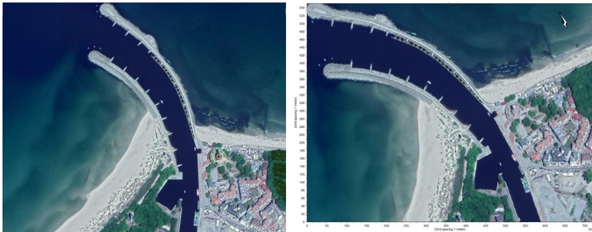
Rys. 8. Obrót układu odniesienia w modelu numerycznym. a) rzeczywisty układ portu zorientowany do kierunku N b) obrót układu odniesienia w modelu
