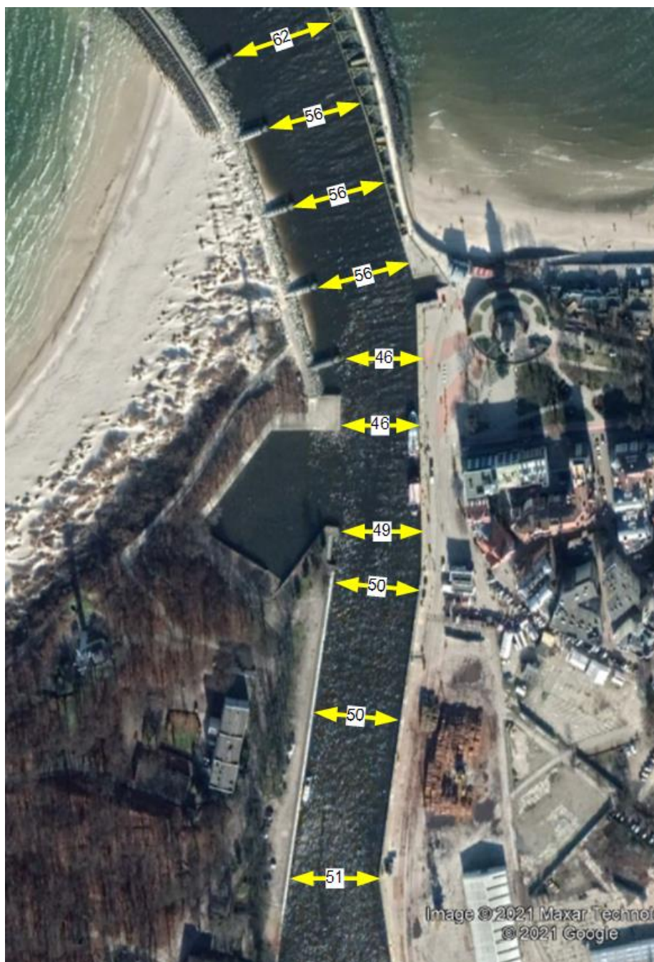
Rys. 4.1. Szerokości dostępne kanału portowego w Kołobrzegu
